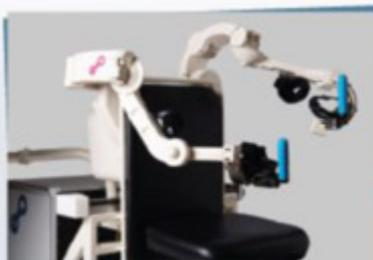
Il Track-hold è un dispositivo riabilitativo per l'allenamento passivo dell'arto superiore con supporto della gravità nei movimenti spaziali. Il rilevamento del movimento dell'intero movimento del braccio è garantito da nuove tecnologie di rilevamento della posizione integrate.
